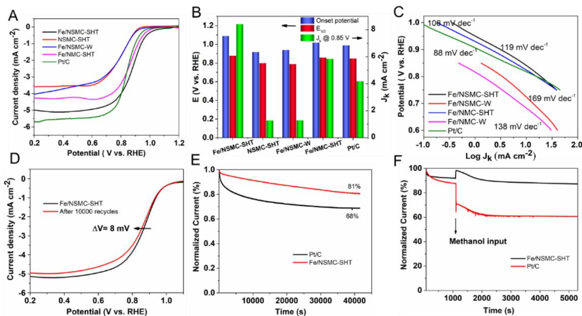
Figure 1. (A) Courbes de polarisation ORR, (B) Potentiel d'apparition, potentiel demi-onde ( $E_{1/2}$ ) et densité de courant cinétique ( $J_k$ ) pour différents catalyseurs, (C) Courbes de Tafel pour les catalyseurs préparés, (D) Test de durabilité accéléré (ADT) pour Fe/NSMC-SHT, (E) Réponse CA pour Fe/NSMC-SHT, (F) Test de tolérance au méthanol pour Fe/NSMC-SHT.
