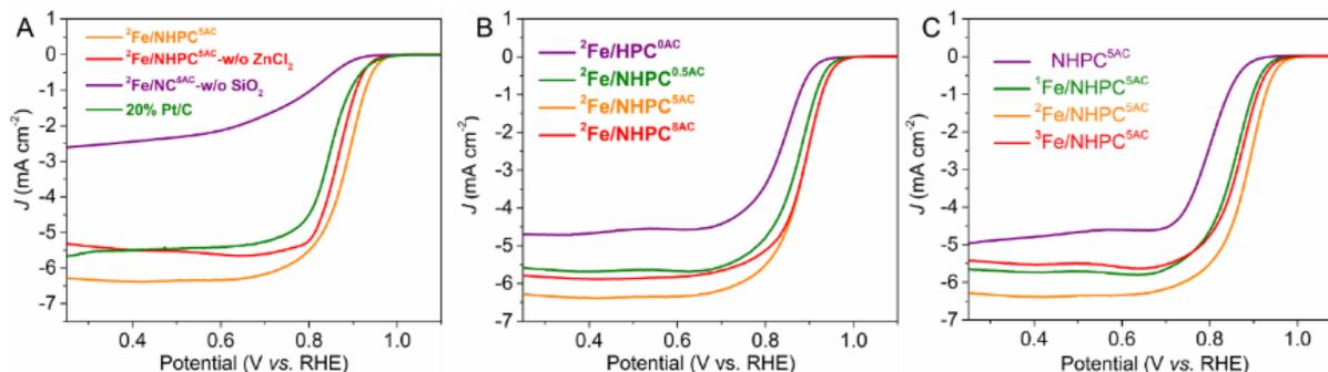
Figure 3. Courbes LSV (A) des catalyseurs de contrôle, (B) les catalyseurs produits par différentes additions de (NH<sub>4</sub>)<sub>2</sub>CO<sub>3</sub>, et (C) les catalyseurs obtenus par diverses charges de Fe. Toutes les données sont enregistrées sous O<sub>2</sub> saturée en solution KOH à 0.1 M pour des vitesses de balayage de 10 mV · s<sup>-1</sup> et de rotation de 1600 tours par minute.
