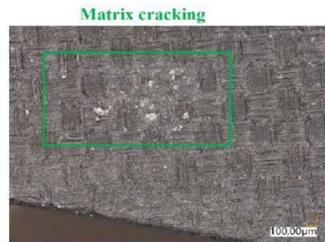
(d) Zone 2 of 5.5% MC specimen Wet H1.
