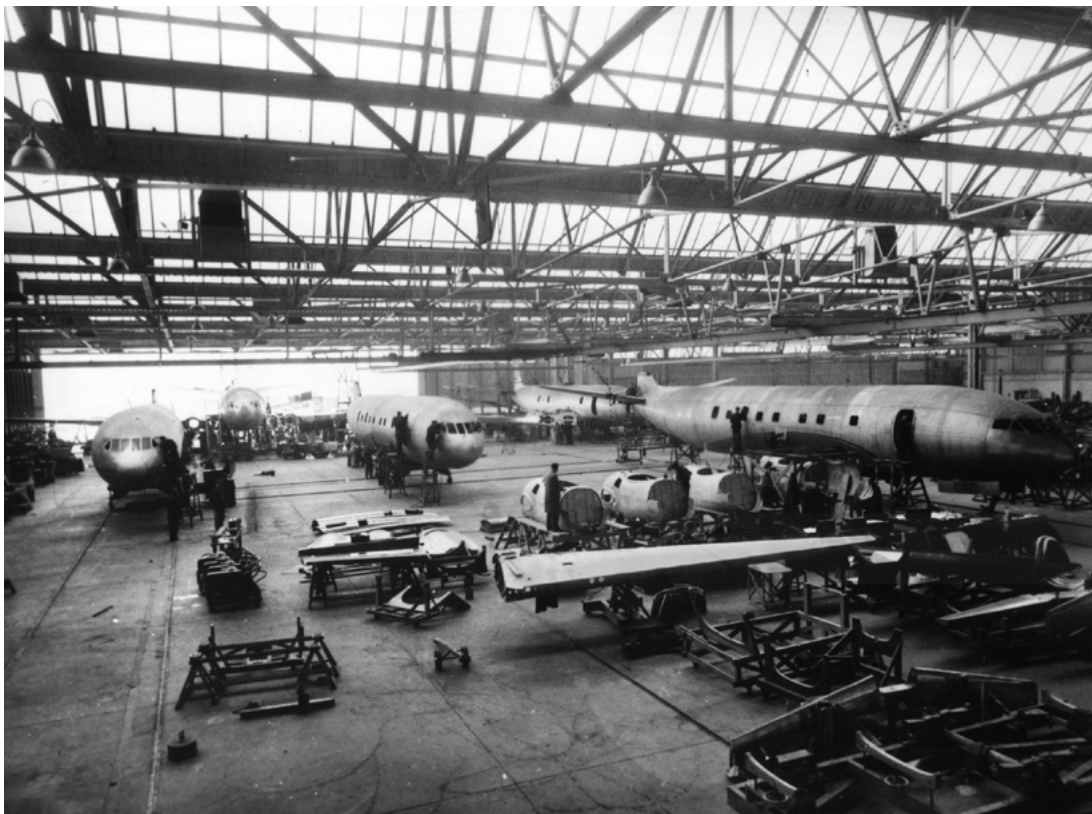
Fig. 136 Intérieur de l'usine De Havilland à Hatfield (Hertfordshire) où des ouvriers construisent les avions de ligne à réaction Comet en 1950
