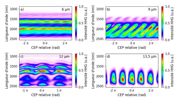
Figure 2.42 : Evolution du spectre HHG en fonction de la CEP dans un polycristal de ZnSe d'épaisseur 0,5~mm pour des longueurs d'onde fondamentales centrées à a)  $6~\mu m$ , b)  $9~\mu m$ , c)  $12~\mu m$  et d)  $13,5~\mu m$ .
