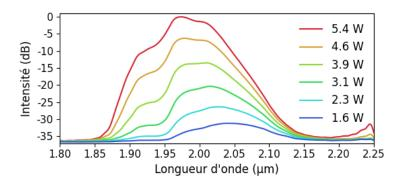
Figure 4.17 : Emission spontanée amplifiée d'une fibre Tm-Ho 6/130 de 5 mètres en fonction de la puissance de pompage à 793 nm.
