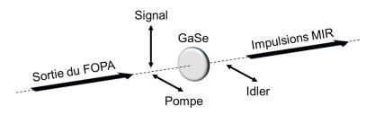
Figure 2.31 : Accord de phase de type-II dans un cristal de Séléniure de Gallium (GaSe) pour la génération d'idler par différence de fréquences (DFG). Les flèches doubles représentent les polarisations du signal, de la pompe et de l'idler dont la propagation est colinéaire à l'axe optique (en pointillés).
