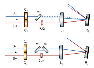
Figure 2.13 : En haut, dispersion angulaire induite par une fenêtre  $W_1$  à incidence non nulle dans le plan de Fourier. En bas, compensation du défaut avec une deuxième fenêtre  $W_2$  d'orientation opposée.
