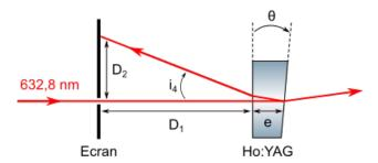
Figure 4.35 : Mesure du défaut de parallélisme d'une céramique Ho:YAG à partir de la réflexion d'un laser HeNe à 632,8 nm.
