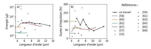
Figure 2.5 : Etat de l'art des sources lasers femtosecondes d'énergie supérieure à 1 microjoule dans l'infrarouge moyen. Les lignes font référence aux sources accordables.
