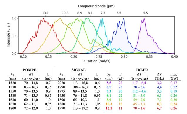
Figure 2.35 : Accordabilité de la source dans l'infrarouge moyen avec (en haut) le spectre idler généré par DFG pour différentes configurations du FOPA et (en bas) les propriétés de la pompe, du signal et de l'idler associées à chacun des résultats.
