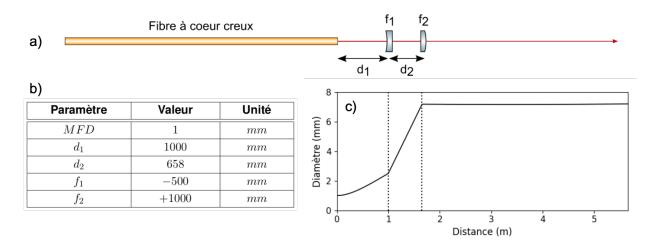
Figure 2.11 : a) Schéma de collimation du faisceau en sortie de fibre à cœur creux, b) dimensionnement des paramètres et c) simulation de propagation jusqu'à l'entrée du FOPA.
