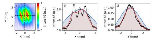
Figure 2.27 : a) Mode transverse en sortie de FOPA d'une bande spectrale centrée à 1900 nm amplifiée par une pompe de durée 1,15 picoseconde. b) Projection sur l'axe de dispersion (X) avec le profil non amplifié (bleu), le profil amplifié au centre du faisceau (noir) et le profil amplifié intégré (rouge). c) Projection sur l'axe non dispersé (Y) avec le même code couleur.
