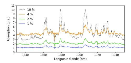
Figure 4.24 : Absorption de céramiques YAG dopées à 1%, 2%, 4% et 10% d'ions Holmium.
