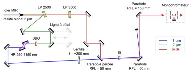
Figure 2.37 : Montage expérimental de caractérisation FROSt, avec LP 2500/3500 des filtres interférentiels passe-haut 2500/3500 nm, HR 920-1150 des optiques réflectives entre 920 nm et 1150 nm et Si un cristal de Silicium.
