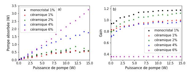
Figure 4.31 : a) Pompe absorbée à 1939,4 nm et b) gain à 2090 nm dans des céramiques Ho:YAG dopées à différentes concentrations d'ions actifs.
