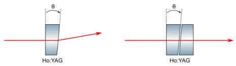
Figure 4.37 : A gauche, faisceau dévié par une céramique à faces non parallèles. À droite, compensation du défaut avec une deuxième céramique d'orientation opposée.
