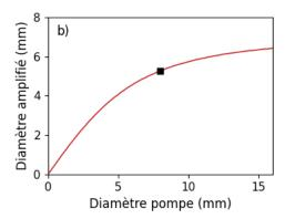
Figure 2.19 : a) Profils de pompe (violet), signal (noir) et signal amplifié (rouge) théoriques dans le plan de Fourier sur l'axe non dispersé du FOPA et b) dimension du faisceau amplifié en fonction de la taille de la pompe pour un signal de 7 mm de diamètre. Le point de fonctionnement théorique (carré noir) correspond à une pompe de 8 mm.
