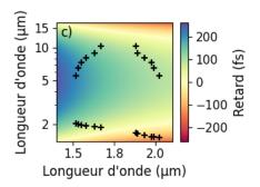
Figure 2.33 : a) Indice de réfraction et b) vitesse de groupe dans un cristal GaSe. Les hachures bleues, vertes et rouges réfèrent respectivement aux longueurs d'onde de la pompe, du signal et de l'idler. c) Retard de groupe introduit par 0,75 mm de propagation, avec les longueurs d'onde pompe/signal/idler expérimentales repérées en croix noires.
