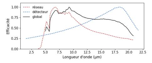
Figure B.1 : Réponse du monochromateur (en noir) entre  $5~\mu m$  et  $20~\mu m$  avec l'efficacité du réseau 75 traits/mm (en rouge) et du détecteur HgCdTe (en bleu).
