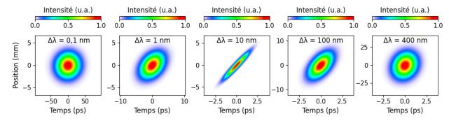
Figure 2.23 : Simulation de distorsion spatiotemporelle après diffraction par un réseau 75 traits/mm et propagation sur une distance 750 mm. Les spectres sont centrés à 1800 nm.
