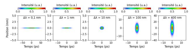
Figure 2.25 : Simulation du front d'impulsion dans le plan de Fourier d'un FOPA constitué d'un réseau de densité 75 traits/mm et d'une lentille de focale 750 mm. Les spectres sont centrés à 1800 nm.
