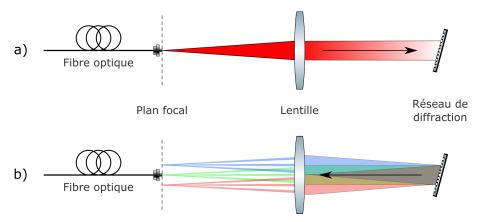
Figure 4.5 : Fonctionnement du filtre accordable a) à l'aller avec une propagation colinéaire pour chaque longueur d'onde et b) au retour avec une dispersion angulaire des composantes spectrales suite à la diffraction par le réseau.
