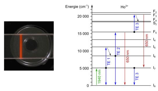
Figure 4.26 : A gauche, fluorescence rouge d'une céramique Ho:YAG pompée à 1940 nm. À droite, diagramme d'énergie de l'Holmium tiré de la référence [161] avec la transition de pompage (vert), les transferts d'énergie croisés (TE, bleu), les transitions non radiatives (noir) et les transitions radiatives vers 650 nm (rouge).
