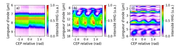
Figure 2.43 : Spectre fondamental à a) 7  $\mu m$  et b) 12  $\mu m$  en fonction de la CEP et c) spectre HHG en fonction de la CEP d'une impulsion fondamentale à 12  $\mu m$ .
