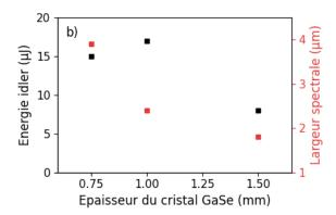
Figure 2.34 : a) Spectre idler généré par deux impulsions centrées à 1625 nm et 1850 nm pour différentes épaisseurs de GaSe. b) Energie (en noir) et largeur spectrale (en rouge) de l'idler en fonction de l'épaisseur du cristal.
