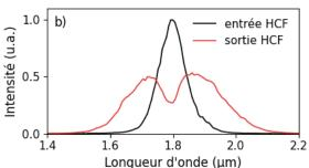
Figure 2.8 : a) Spectre de la source Titane:Saphir avant conversion dans le TOPAS et b) élargissement spectral dans la fibre à cœur creux remplie avec 1,7 bar de Krypton.
