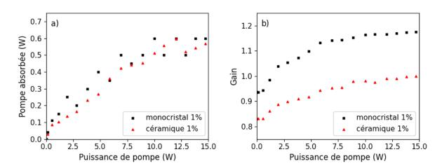
Figure 4.29 : a) Pompe absorbée à 1939,4 nm et b) gain brut à 2090 nm dans un monocristal (noir) et une céramique (rouge) Ho:YAG dopés à 1%.
