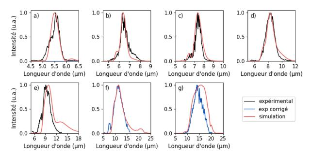
Figure 2.36 : Spectres idler expérimentaux (en noir) et simulés (en rouge) pour différentes longueurs d'onde d'émission de la source MIR. Les spectres f) et g) à hautes longueurs d'onde (en bleu) ont été corrigés par la transmission des filtres et la sensibilité du monochromateur (cf annexe B).
