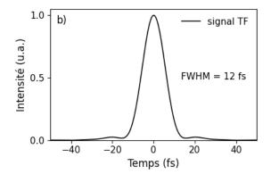
Figure 3.3 : a) Spectre signal après propagation dans la fibre à cœur creux remplie et filtrage des basses longueurs d'onde par un filtre interférentiel passe-haut 950 nm, b) durée d'impulsion en limite de Fourier.
