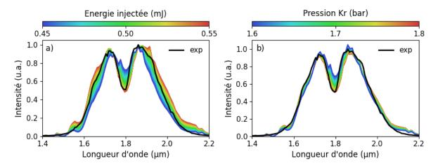
Figure 2.10 : Simulation de propagation Kerr optique dans la fibre à cœur creux avec une variation a) de l'énergie injectée et b) de la pression de Krypton dans la fibre. Le spectre expérimental est indiqué en noir.
