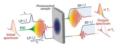
Figure C.1 : Tirée de la référence [88] : Principe de fonctionnement du FROSt avec ls la source de photoexcitation, P(t) l'impulsion sonde et S la réponse de transmission du matériau.
