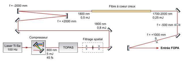
Figure 2.7 : Mise en forme du signal avant injection dans le FOPA. Le laser Ti:Sa est converti à 1,8  $\mu m$ , filtré spatialement, élargi spectralement dans une fibre à cœur creux remplie au Krypton, puis collimaté à un diamètre de 7 mm.
