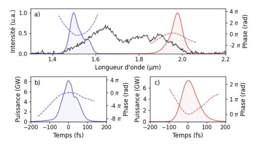
Figure 2.32 : a) Spectre signal non amplifié (en noir) et amplifié (en bleu et rouge) dans le FOPA. b-c) Caractérisation temporelle SHG-FROG des impulsions amplifiées avec la phase en pointillés.
