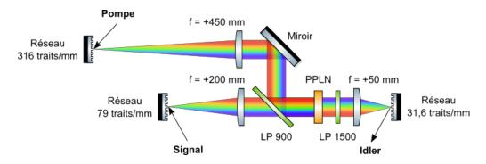
Figure 3.4 : Architecture de DFG dans un plan de Fourier avec PPLN un cristal de Niobate de Lithium polarisé périodiquement et LP 900/1500 des filtres interférentiels passe-haut à respectivement 900 nm et 1500 nm.
