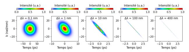
Figure 2.26 : Simulation de rotation temporelle de front d'onde dans le plan de Fourier d'un FOPA constitué d'un réseau de densité 75 traits/mm et d'une lentille de focale 750 mm. Les spectres sont centrés à 1800 nm.
