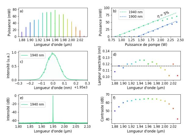
Figure 4.10 : Caractérisation de l'oscillateur Thulium avec a) l'accordabilité spectrale, b) l'efficacité laser à 1900 nm (bleu) et 1940 nm (vert), c) le spectre à 1950 nm, d) la largeur spectrale à mi-hauteur en fonction de la longueur d'onde d'émission, e) le contraste à 1950 nm et f) le contraste en fonction de la longueur d'onde d'émission.
