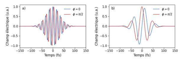
Figure 2.41 : Champ électrique de deux impulsions de 50 fs centrées à a)  $5~\mu m$  et b)  $15~\mu m$  pour des valeurs de CEP de 0 radians (bleu) et  $\pi/2$  radians (rouge).
