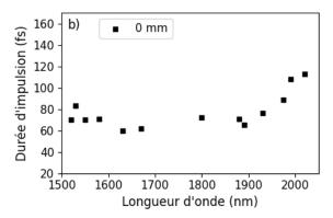
Figure 2.30 : Durée des impulsions en sortie de FOPA (noir) et après compression dans une fenêtre en silice d'épaisseur 25 mm (rouge). Les fenêtres a) et b) correspondent à deux expériences menées sur le même montage expérimental mais avec une phase résiduelle différente sur la source Ti:Sa.
