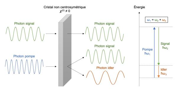
Figure 1.2 : A gauche, amplification d'un signal et génération d'un idler par amplification paramétrique optique. À droite, diagramme d'énergie des photons de pompe, signal et idler.
