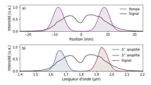
Figure 2.17 : Simulation de gain paramétrique en régime petit signal dans le FOPA avec a) la répartition d'intensité spatiale du signal (noir) et des deux pompes (violet) et b) le spectre du signal incident (noir) et le spectre amplifié (rouge et bleu).
