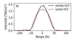
Figure 2.9 : Simulation de propagation Kerr optique dans une fibre à cœur creux remplie au Krypton dans le domaine a) spectral et b) temporel.
