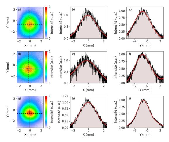
Figure 2.29 : a-c) Mode transverse en champ lointain du FOPA d'une bande amplifiée à 1900 nm, d-f) d'une bande amplifiée à 1700 nm et g-i) des deux bandes superposées, avec X l'axe de dispersion du FOPA et Y l'axe non dispersé.
