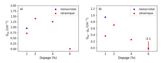
Figure 4.33 : a) Coefficient d'émission stimulée et b) gain net attendu en l'absence de diffusion à 2090 nm dans des céramiques Ho:YAG dopées avec différentes concentrations d'ions actifs.
