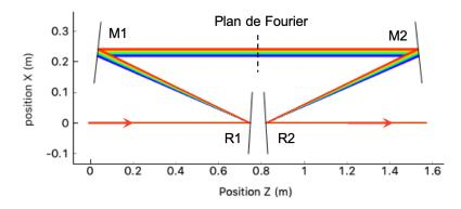
Figure 2.4 : Simulation de propagation d'une impulsion centrée à 1800 nm et de largeur spectrale 450 nm dans une ligne 4f, avec R1/R2 des réseaux 75 traits/mm et M1/M2 des miroirs sphériques de focales 750 mm.
