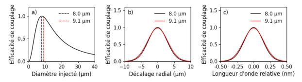
Figure 4.8 : Efficacité de réinjection dans la fibre de sortie du filtre accordable en fonction a) du diamètre du faisceau, b) du décalage radial du faisceau et c) de la longueur d'onde en valeur relative par rapport à 1950 nm.
