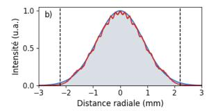
Figure 4.7 : Mode spatial aller (bleu) et retour (rouge) dans le filtre accordable a) en extrémité de fibre optique et b) dans le plan de la lentille. L'ouverture de la lentille est indiquée en pointillés noirs.
