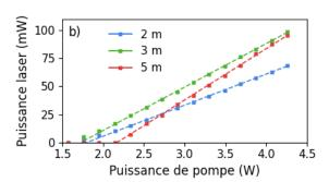
Figure 4.18 : a) Accordabilité de l'oscillateur Tm-Ho pour un pompage à 3,9 Watts et b) efficacité à 2050 nm pour différentes longueurs de fibre amplificatrice.
