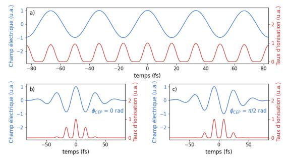
Figure 1.4 : Modélisation du champ électrique (bleu) et du taux d'ionisation (rouge) produits par des impulsions de a) 300 fs et b,c) 30 fs centrées à  $10~\mu m$ .
