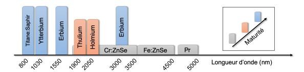
Figure 1.1 : Milieux amplificateurs utilisés pour générer des impulsions femtosecondes par émission stimulée dans l'infrarouge proche et l'infrarouge moyen.
