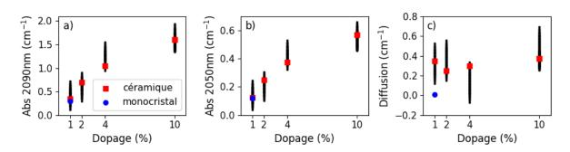
Figure 4.23 : a-b) Coefficient d'absorption à 2090 nm et 2050 nm dans des matériaux Ho:YAG à différents niveaux de dopage. La plage de confiance (barre noire) est calculée pour une incertitude de  $\pm 2,5\%$  sur les mesures de transmission.
