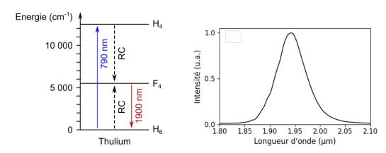
Figure 4.4 : A gauche, diagramme d'énergie de l'ion Thulium avec la transition de pompage (en bleu), la relaxation croisée RC (en pointillés noirs) et la transition d'émission vers 1900 nm (en rouge). À droite, spectre d'émission spontanée amplifiée mesuré sur une fibre Nufern PM-TDF-10P/130-HE pompée à 793 nm.
