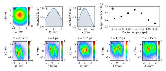
Figure 2.20 : a) Mode transverse d'un signal non amplifié en sortie de FOPA et intégration du profil sur b) l'axe dispersé et c) l'axe non dispersé. d) Amplification d'un signal centré à 1900 nm en fonction de la durée d'impulsion de la pompe et e-i) profil spatial du signal amplifié en sortie de FOPA en fonction de la durée de la pompe.
