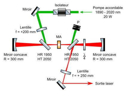
Figure 4.34 : Cavité laser bi-concave avec MA le milieu amplificateur, P des diagnostics de puissance,  $\lambda/4$  une lame de phase quart d'onde et HR/HT les optiques de couplage de la pompe et du signal.
