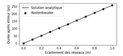
Figure 2.3 : Simulation d'étirement dans un compresseur à réseaux en résolution analytique (ligne noire) et avec le formalisme Kostenbauder (carrés noirs).
