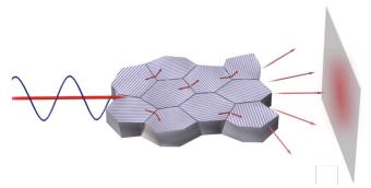
Figure 4.21 : Tirée de la référence [155]. Illustration de la diffusion de Mie dans une céramique dont la dimension des grains est comparable à la longueur d'onde.
