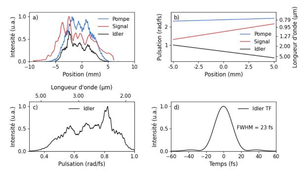
Figure 3.5 : Simulation de DFG dans l'espace des fréquences avec a-b) la distribution des spectres de pompe (bleu), signal (rouge) et idler (noir) dans le PPLN, c) le spectre de l'idler et d) la durée d'impulsion de l'idler en limite de Fourier.
