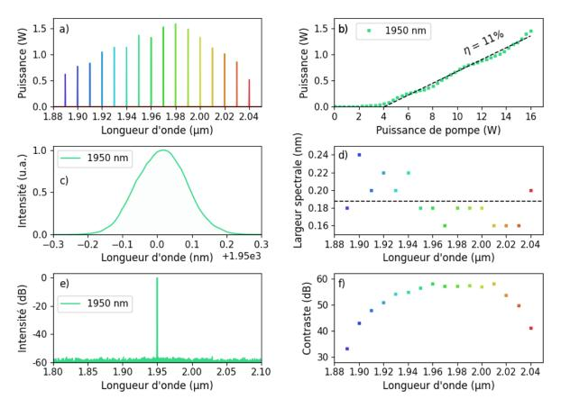
Figure 4.12 : Caractérisation du premier étage d'amplification Thulium avec a) l'accordabilité spectrale, b) l'efficacité laser 1950 nm, c) le spectre à 1950 nm, d) la largeur spectrale à mi-hauteur en fonction de la longueur d'onde amplifiée, e) le contraste à 1950 nm et f) le contraste en fonction de la longueur d'onde amplifiée
