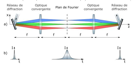
Figure 1.3 : a) Imagerie 4f avec f la distance focale des optiques convergentes, b) évolution de la durée d'impulsion au cours de la propagation avec I l'intensité et t le temps.
