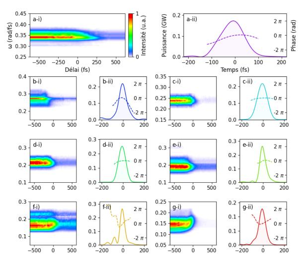
Figure 2.38 : i) Traces FROSt expérimentales et ii) reconstructions temporelles pour a-g) différentes longueurs d'onde d'émission de la source MIR. La phase temporelle est tracée en pointillés et le code couleur fait référence à celui de la figure 2.35.
