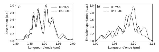
Figure 4.2 : a) Absorption et b) émission spontanée de l'ion Holmium dans des matrices YAG (lignes continues) et LuAG (lignes discontinues). Les données sont extraites de la référence [122].
