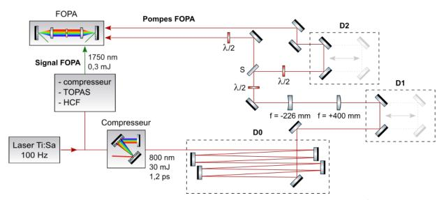
Figure 2.14 : Mise en forme de la pompe du FOPA avec Ti:Sa le laser source, D0 une ligne à retard fixe, D1 et D2 des lignes à retard réglables,  $\lambda/2$  des lames de phase demi-onde, et S une lame séparatrice 50/50.
