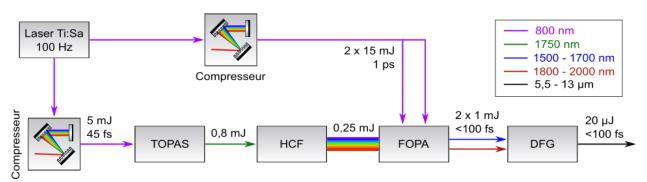
Figure 2.6 : Architecture de la source MIR avec un laser Titane:Saphir (Ti:Sa), un amplificateur paramétrique optique industriel TOPAS, une fibre à cœur creux (HCF), un amplificateur paramétrique optique dans l'espace des fréquences (FOPA) et un étage d'amplification paramétrique optique utilisé pour générer un idler par différence de fréquences (DFG).
