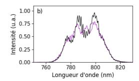
Figure 2.28 : a) Spectres des deux faisceaux de pompe de durée 2 ps dans le plan de Fourier et b) spectre d'une pompe de 2 ps (violet) et 1,15 ps (noir).
