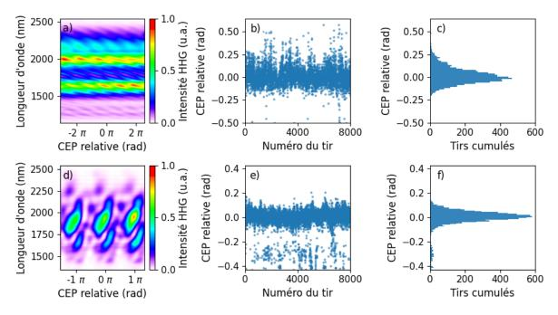
Figure 2.40 : Caractérisation de la CEP à  $6~\mu m$  (en haut) et  $13~\mu m$  (en bas) avec de gauche à droite le spectre HHG moyenné 100 fois en fonction de la CEP en valeur relative, la valeur de CEP tir à tir et l'histogramme de la CEP.
