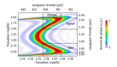
Figure 3.2 : Accord de phase dans un PPLN de période  $21,2~\mu m$  et d'épaisseur 0,5~mm à température ambiante. Les données sont tirées du logiciel libre "SPDCalc.org".
