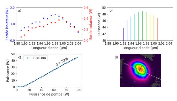
Figure 4.14 : Performances du deuxième étage amplificateur avec a) la transmission de l'isolateur, b) l'accordabilité spectrale, c) l'efficacité à 1940 nm et d) le mode spatial mesuré à 1,5 mètre de la sortie laser à la longueur d'onde 1932,5 nm.
