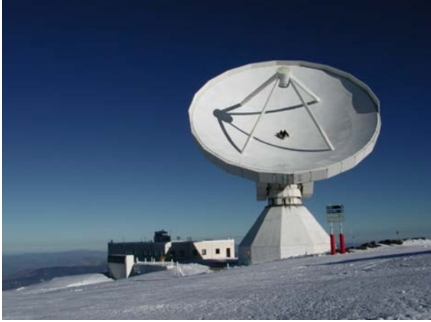
Figure II.4: IRAM 30-m Pico Veleta, Sierra Nevada Grenade. Cassegrain, de 70 à 350 GHz.
