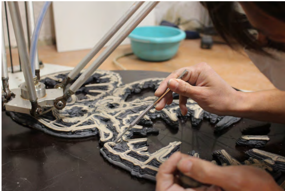
Figure 84 — A. Photographie de l'imprimante 3D en argile (type Delta) conçue par Olivier Van Herpt au 8FabLab de Crest (Drôme) B. Photographie de gestes en cours d'impression d'un fragment de la pièce Archive vivante, Fragments coralliens : Caryophyllia clavus .
