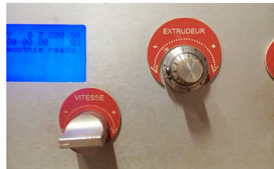
Figure 83 — Photographie des réglages présents sur le contrôleur de la machine d'impression 3D en argile conçue par le designer Olivier Van Herpt.
