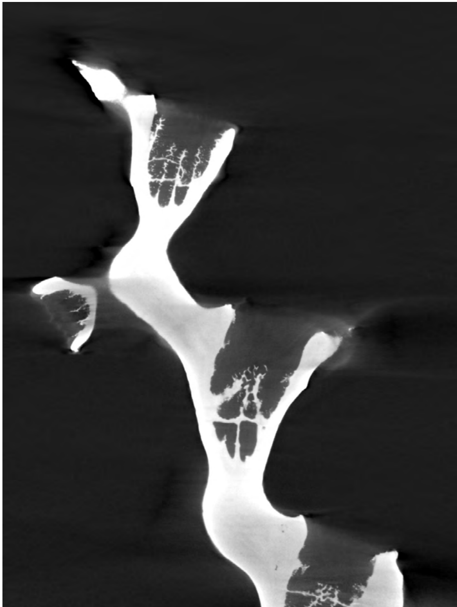
Figure 53 — Extrait d'un stack (pile d'images) du scan d'un squelette de profondeur de l'espèce Madrepora oculata réalisé par tomographie à rayons X. Ce procédé permet de reconstituer un modèle 3D à haute résolution. Ces images ont été réalisées à l'Institut de Mécanique des Fluides de Toulouse (IMFT). Le spécimen appartient à la collection de travail de Franck Lartaud (LECOB).
