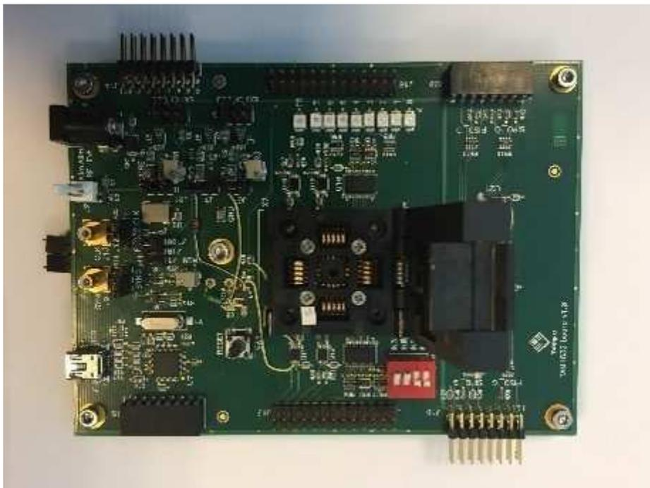
Figure 73 : Carte de test pour le circuit TACO.
