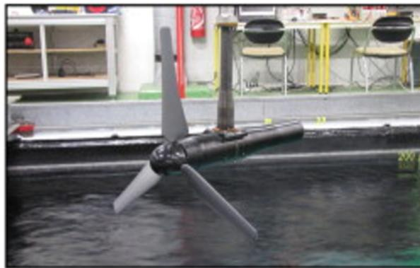
**Figure 3.3:** Maquette d'hydrolienne (Mycek *et al.*, 2014a)
