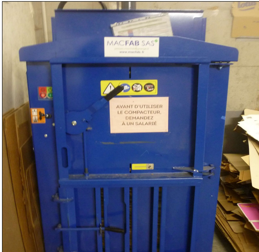
Illustration 37 : Le compacteur du supermarché avec une affiche précisant la nécessaire présence d'un salarié (photo de l'auteur)
