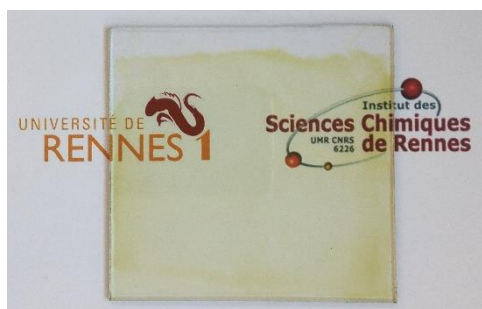
Figure 70. Photographie d'un film de \{Nb_6Cl_{12}\}@SiO_2 -PEG déposé sur un substrat en verre (10 cm × 10 cm).
