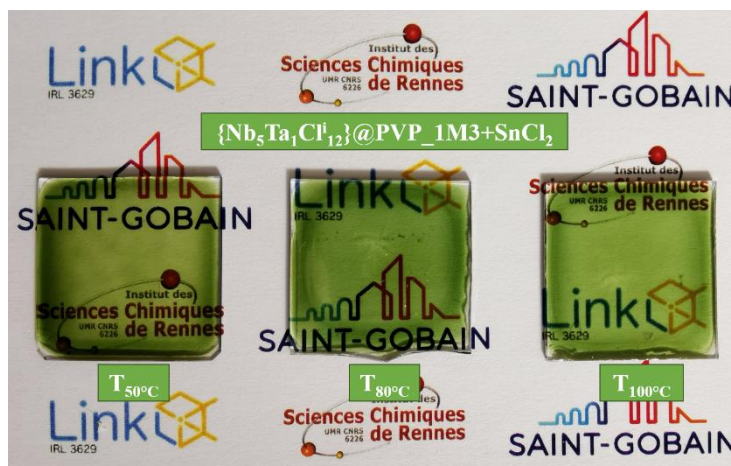
Figure 87. Photographie des films de \{Nb_5Ta_1Cl_{12}\}@PVP\_1M3 réduit par SnCl_2 . Les films ont subi des traitements thermiques différents et sont photographiés un an après ce traitement thermique.
