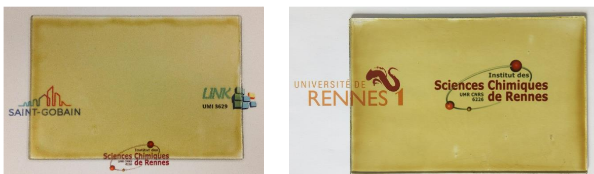
Figure 71. Photographies de films de \{Nb_6Cl_{12}\}@SiO_2 -PEG déposés sur un substrat en verre (15 cm × 10 cm).
