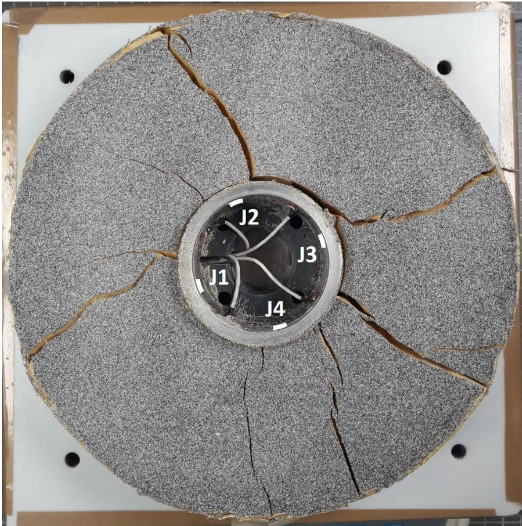
Figure A4.1 : Vue du dessus de l'échantillon E1 à la fin de la dessiccation.
