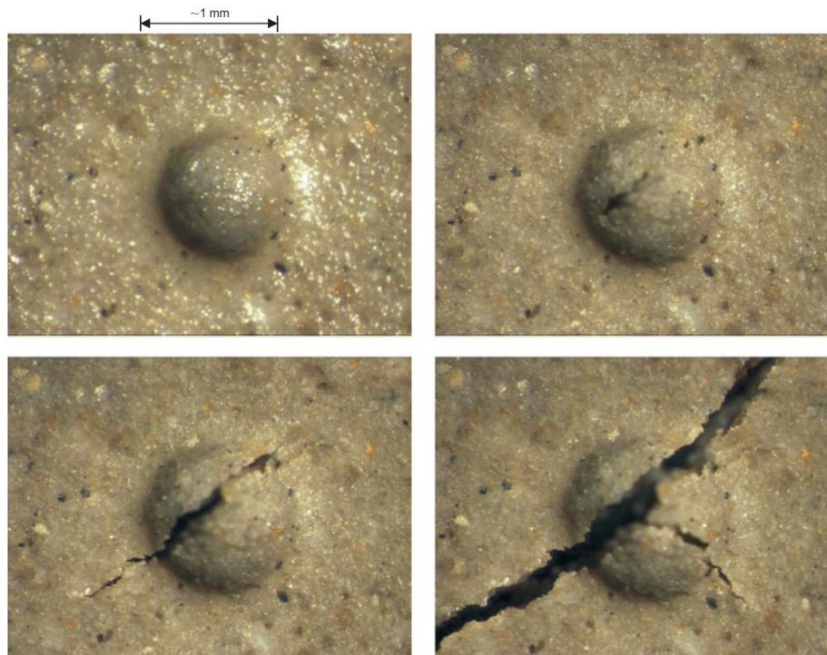
Figure 30: Initiation d'une fissure au fond d'un défaut de surface lors de la dessiccation [Shin, 2011].
