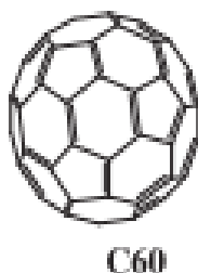
Figure I.17 : Structure chimique du fullerène
