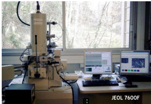
Figure Annexe 2.2: (a) Microscope électronique à balayage (MEB) JEOL 7600 (b) son principe
