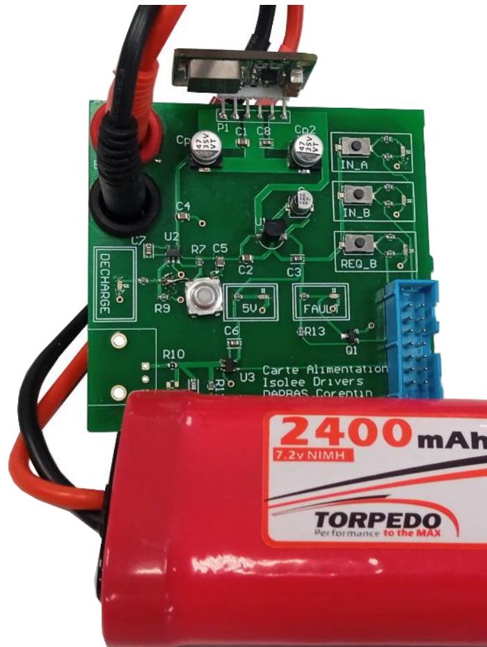
Figure 71. Carte d'alimentation isolée et sa batterie
