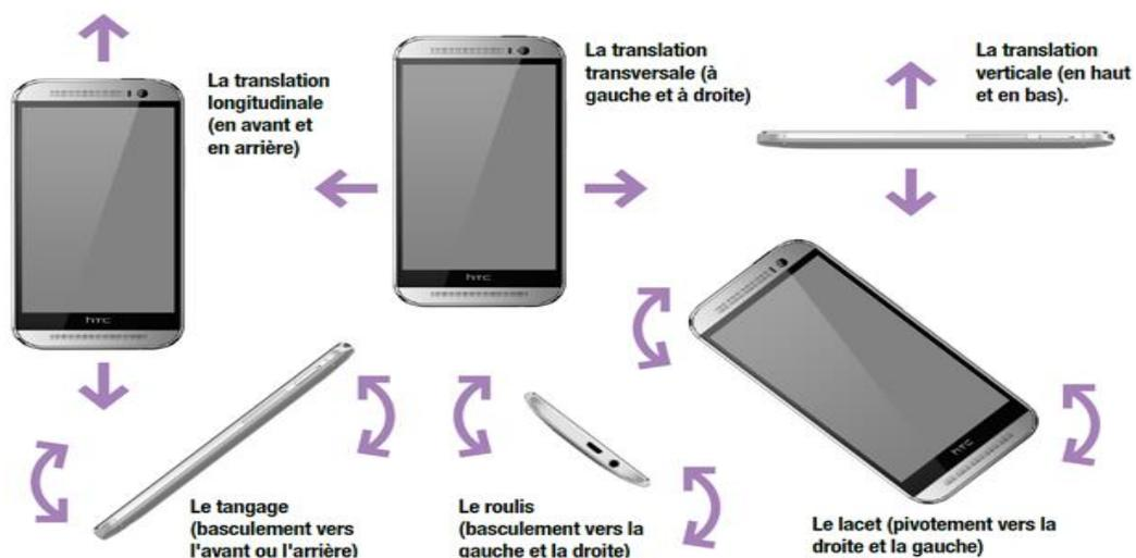
*Figure 14: Différents cas de déplacement d'un smartphone*
