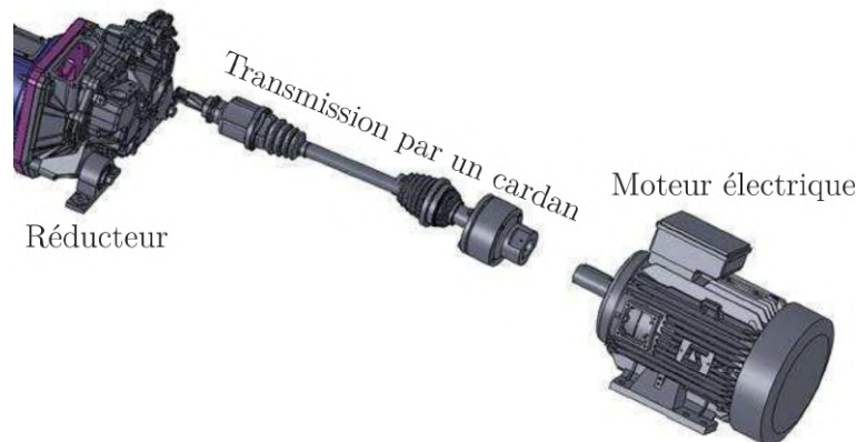
FIGURE III.1.7 – Représentation du dispositif de mise en rotation du rotor
