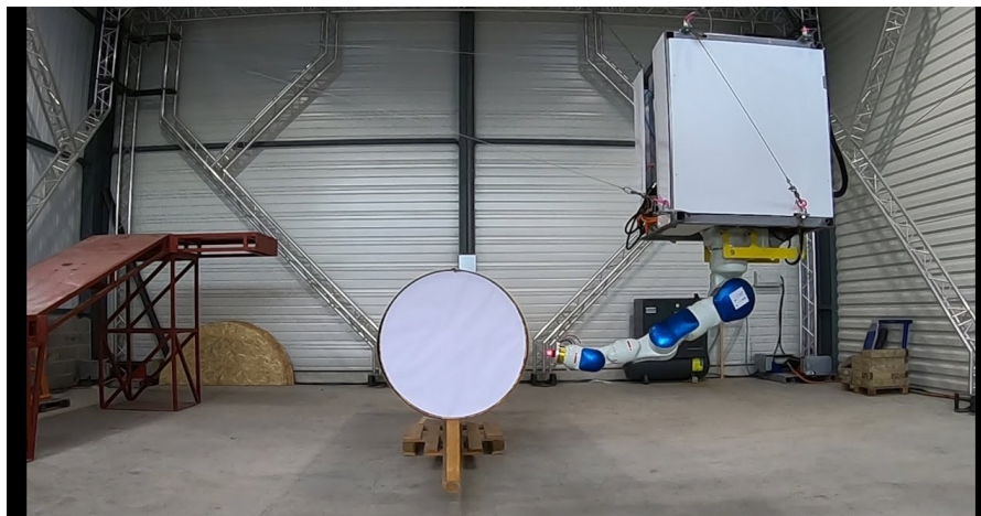
FIGURE 1.1 – Projet ANR DexterWide : robot parallèle à câbles CoGiRo et robot anthropomorphe Yaskawa SIA20F embarqué
