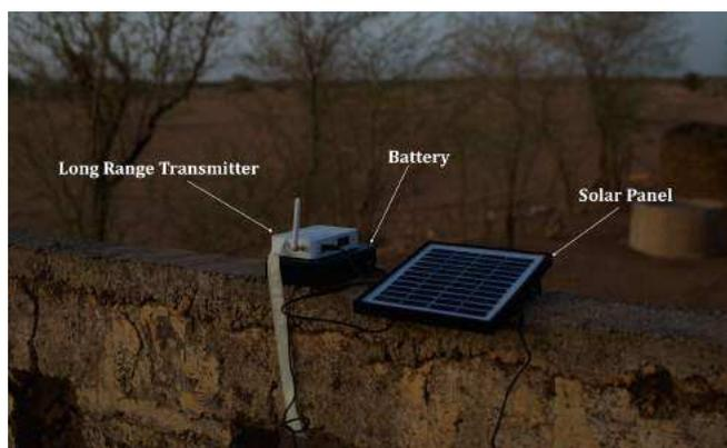
Figure 4.3: Prototype de communication basée sur le WiFi
