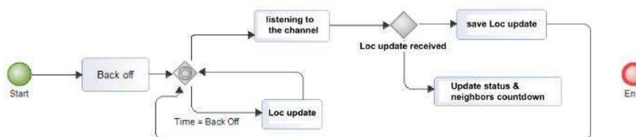
Figure 5.2: Le "Process Overview" de notre modèle.
