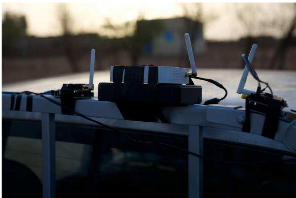
Figure 3.11: Relais Mobile dans un Pick up
