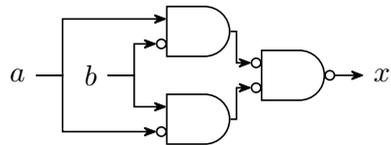
FIGURE A.1. – Circuit associant à  $x$  le résultat du OU exclusif entre les entrées  $a$  et  $b$ . La fonction Booléenne devient alors  $f^x = (a \wedge \bar{b}) \vee (\bar{a} \wedge b)$ . Cette formule est déjà sous forme **ITE** et le circuit **AIG** est décrit ici.
