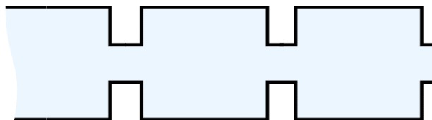
FIGURE 1.6 – Schéma d'un pore cylindrique composé de cavité et de constriction.
