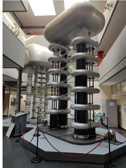
(b) 1 MeV Cockcroft-Walton generator at the "Laboratori Nazionali di Frascati" INFN, Italy.
