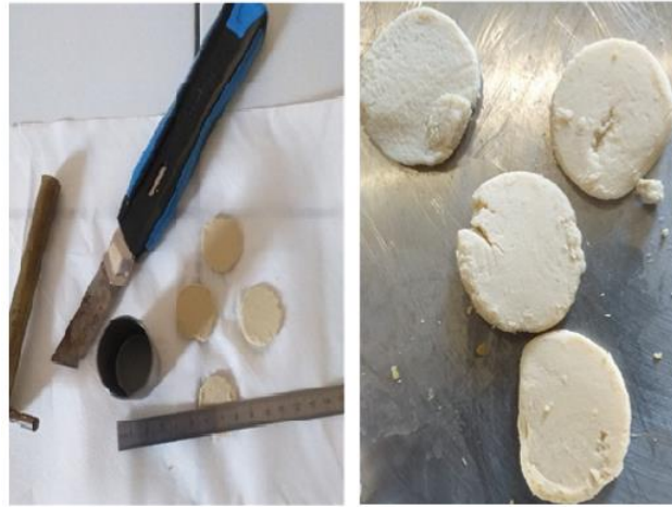
Figure 16: Matériel utilisé pour la découpe des cylindres ; Echantillons après passage au RheoCompass Anton Paar
