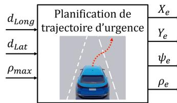
FIGURE 4.3 – Entrées/sortie de la planification de trajectoire d'urgence
