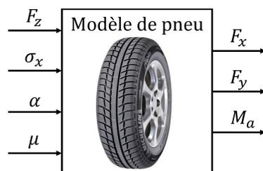
FIGURE 2.11 – Entrées/sorties du modèle de pneu
