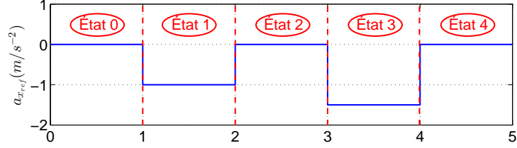
FIGURE 4.8 – Génération de profils d'accélération
