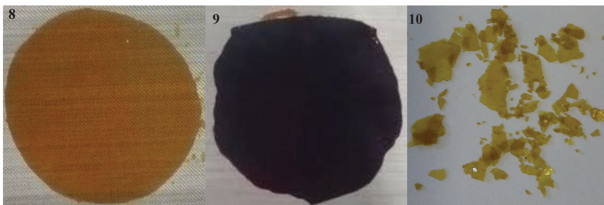
Figure II.11. Les membranes obtenues avec les TPTIs 8-10 .
