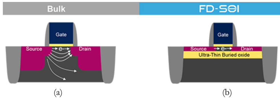
Figure 52. Représentation en coupe d'un transistor bulk (a) et d'un transistor FD-SOI (b)
