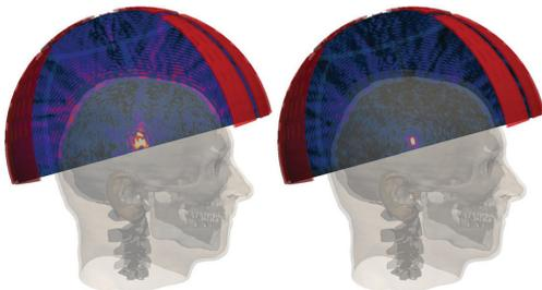
FIGURE 1.15 – Transducteur hémisphérique à commande de phases pour corriger les aberrations dues à l'os crânien (sans correction à gauche, avec correction à droite) (source : [31]).
