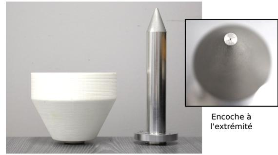
FIGURE 3.33 – À droite : l’outil focal, à gauche, l’équivalent en transducteur-porte-sonde.
