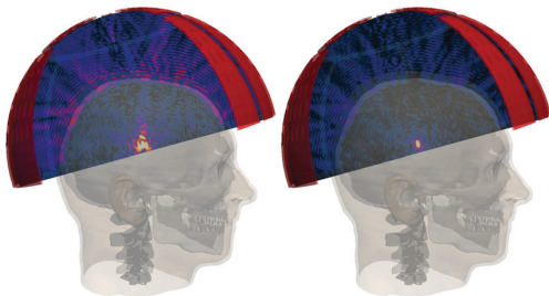
FIGURE 1.15 – Transducteur hémisphérique à commande de phases pour corriger les aberrations dues à l'os crânien (sans correction à gauche, avec correction à droite) (source : [31]).
