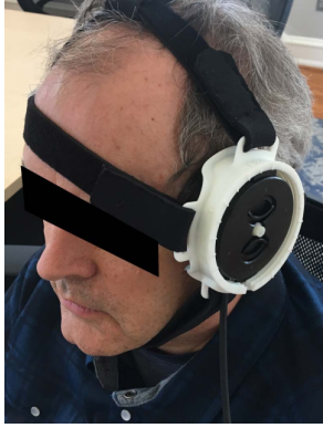
FIGURE 2.5 – Dispositif BX Pulsar 1002, solution clinique proposée par l’entreprise américaine BrainSonix, dont l’architecture globale peut être adaptée à une application d’oBHE avec de l’eau comme milieu de couplage (source : [52]).
