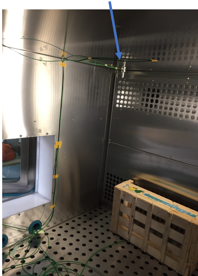
Figure 2.16 Instrument intégré PT-100 à l'intérieure d'une chambre climatique
