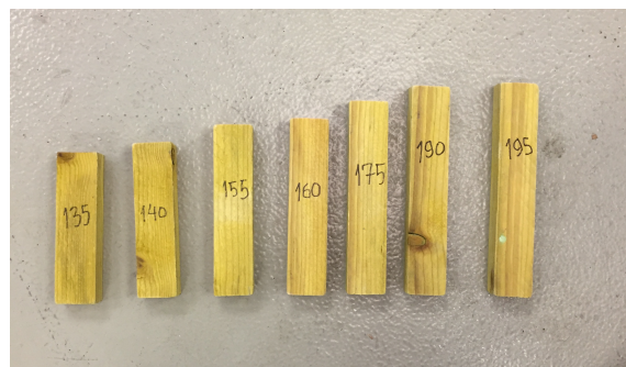
Figure 2.3 Cales utilisées pour moduler l'épaisseur de la lame d'air
