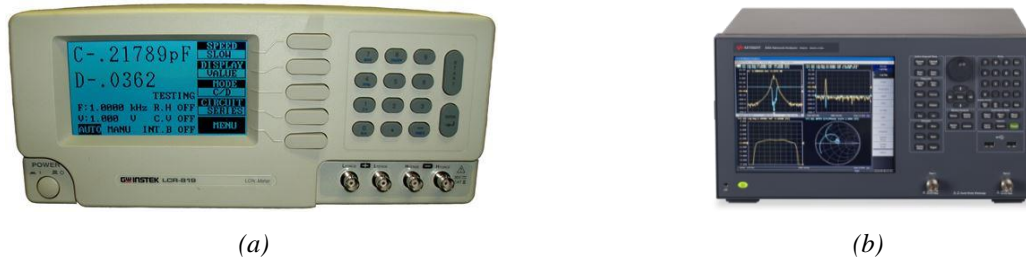
Figure 2.16 : (a) Impédance mètre (Instek LCR Meter-819) et (b) l'analyseur d'impédance (Keysight E5061B ENA LF-RF VNA) de la plateforme MATRIX de l'IETR à l'IUT de Saint Brieuç.
