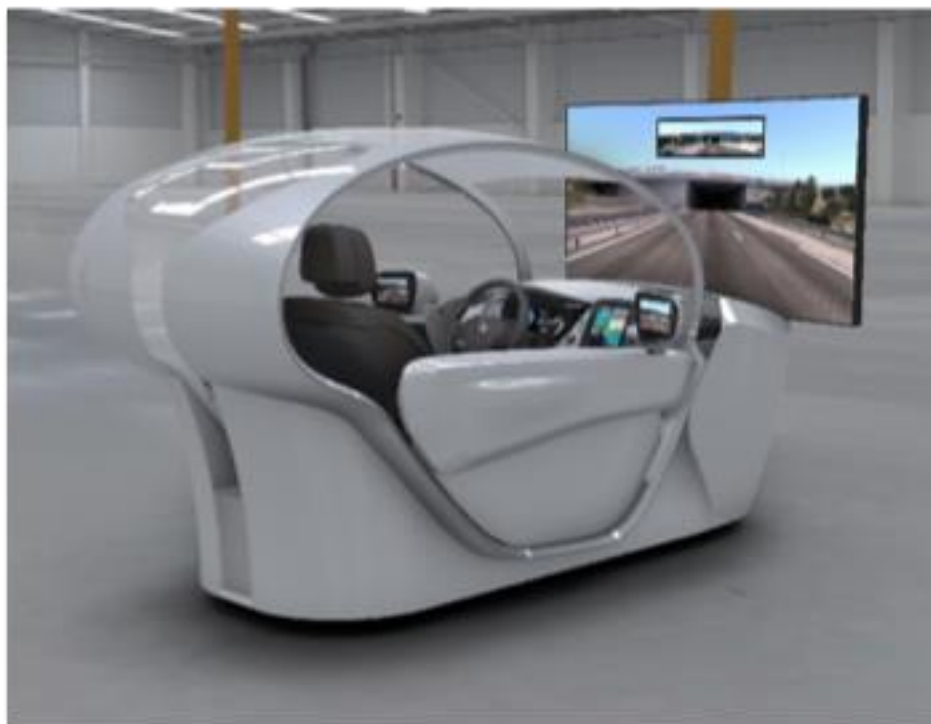
Figure 27 : Simulateur de conduite automatisée Easy Drive Learning développé chez Renault dans le cadre du projet AD Learning.
