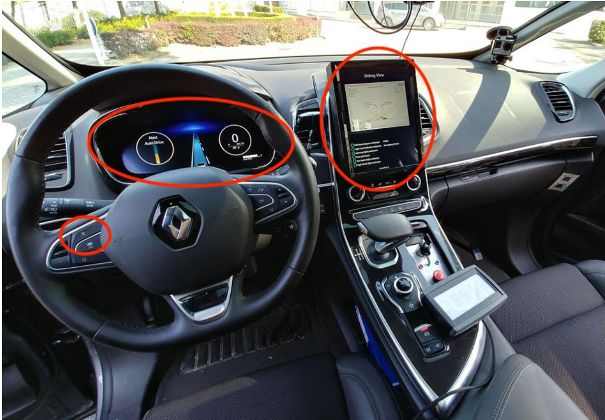
Figure 14 : Poste de conduite du prototype fonctionnel utilisé pour cette étude. Entourés en rouge de gauche à droite : le bouton d'activation « R », l'écran du tableau de bord, l'écran central de supervision.
