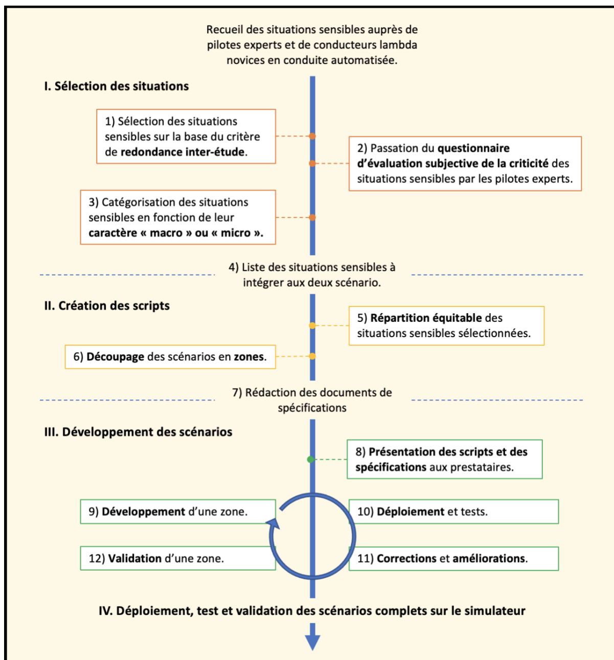
Figure 30 : Schéma récapitulatif du processus de conception des scénarios de simulation de conduite automatisée.
