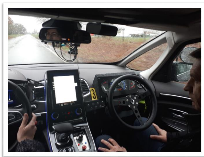
Figure 13 : Système de double commandes installé dans le prototype fonctionnel de véhicule automatisé de Renault. Il est constitué d'un volant, d'un boîtier pour les commodos, de pédales (non visibles) et de rétroviseurs.
