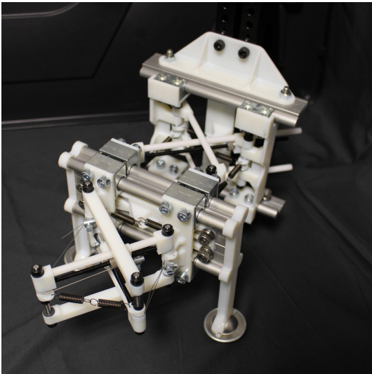
FIGURE 3.19 – Prototype pour l’assemblage par blocs et ses pièces de maintien.
