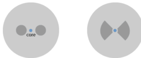
Figure I-7. Fibre à maintien de polarisation (gauche : fibre à structure panda; droite : fibre à structure bow-tie) [48]
