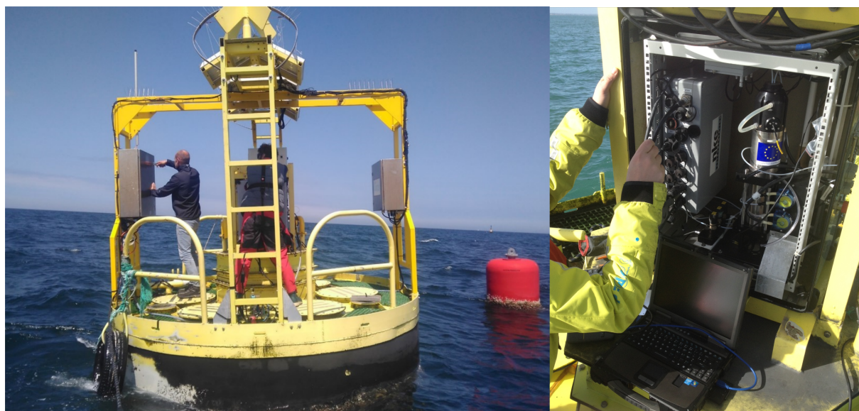
FIGURE 55 – Photographie de la bouée SMILE lors d'une mission de maintenance (Gauche) Photographie du FRRf sur la bouée SMILE (Droite)
