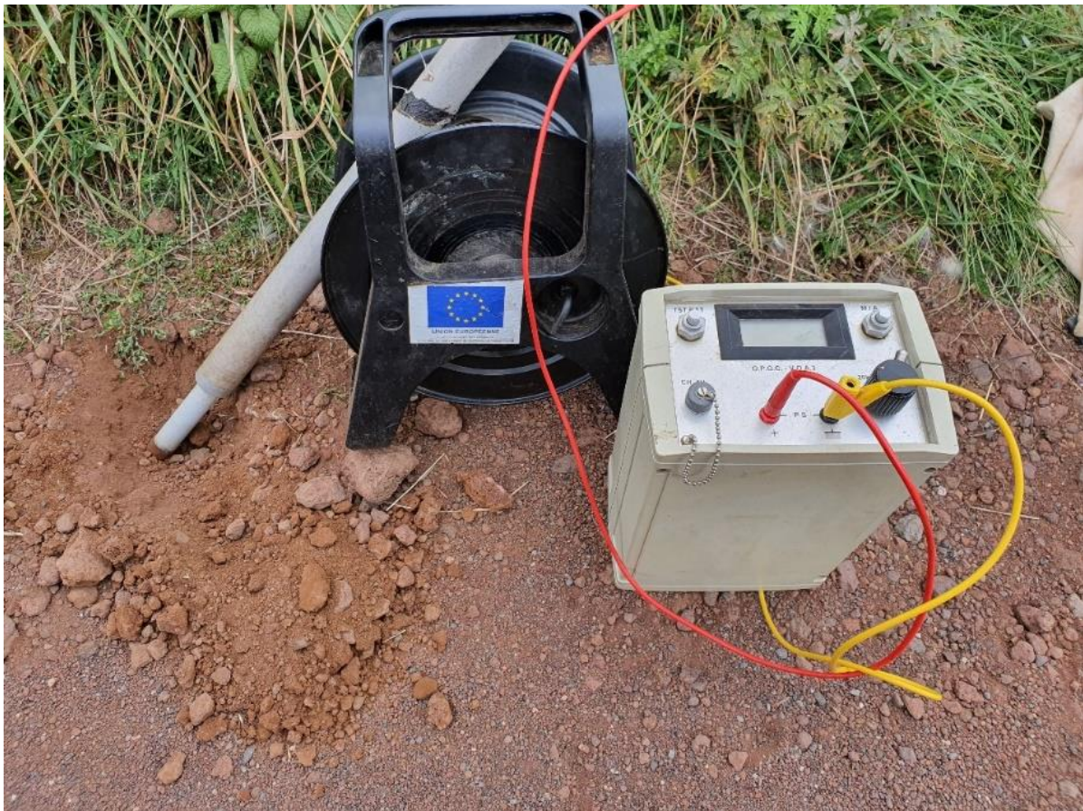
Figure IV.23 : Equipement de mesure de la PS avec une bobine de câble de 1km, un voltmètre haute impédance, une canne où se loge l'électrode de mesure mobile.
