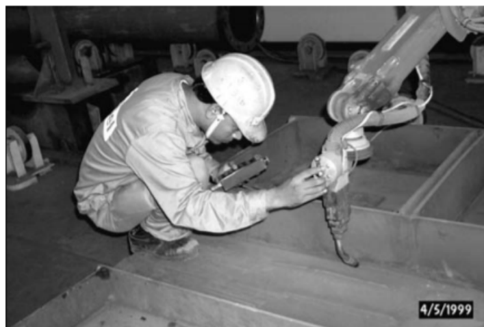
FIGURE II.3 – Guidage manuel pour une opération de soudage [ALL99]
