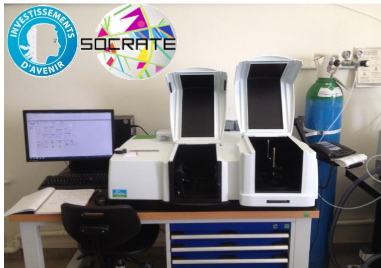
Figure 36 : Spectrophotomètre Lambda 950 Perkin Elmer
