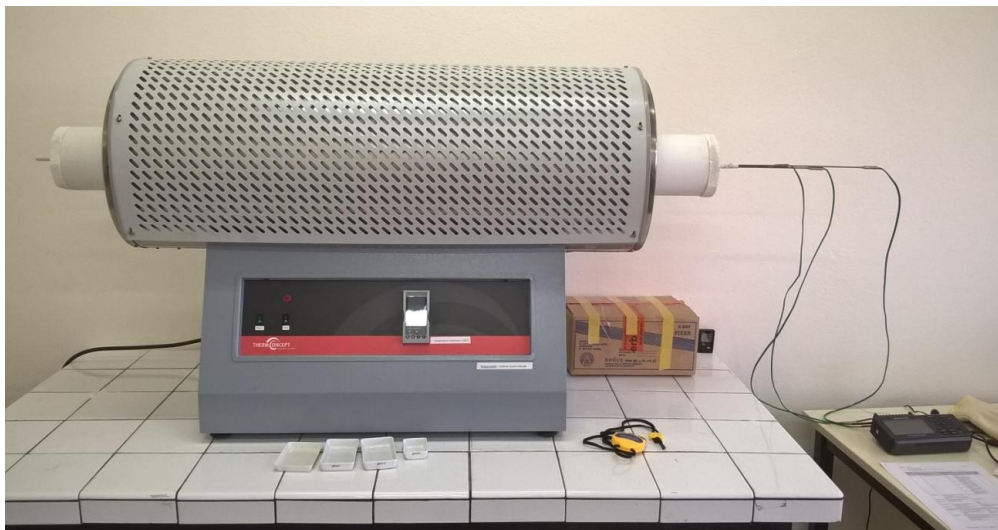
Figure 40 : Banc de vieillissement ALTHAIA
