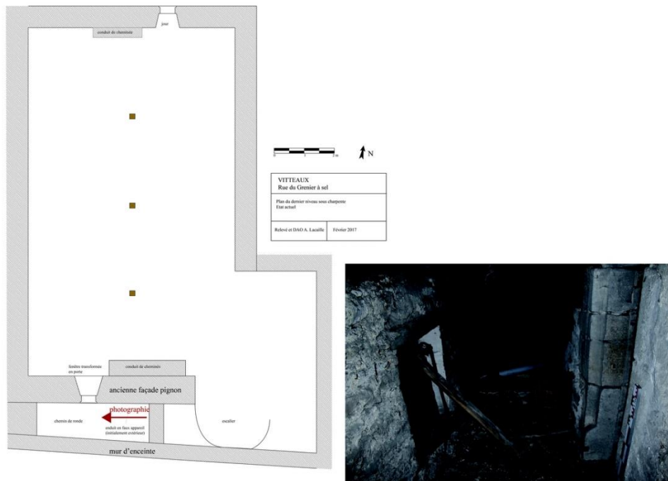
fig. 47 : Relevé en plan et photographie qui illustrent l'érection d'un mur d'enceinte devant une façade médiévale afin de créer un chemin de ronde auprès de la porte fortifiée sud du bourg de Vitteaux
