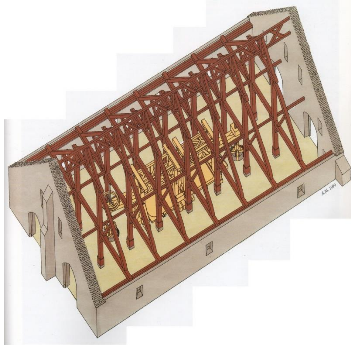
fig. 72 : Restitution axonométrique du Cellier des ducs de Bourgogne à Chenove, avec la charpente et les pressoirs dans l'état des années 1400 (Collectif, Le clos de Chenôve : la cuverie et les pressoirs des ducs de Bourgogne : histoire, archéologie, ethnologie XIII e -XX e siècles : Côte-d'Or, Dijon, Faton, 1999, 62 p).
