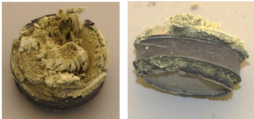
Figure 103 : Photos d'un échantillon fritté de la nuance AHEM15 après traitement thermique pendant 3h à 1000°C sous air.
