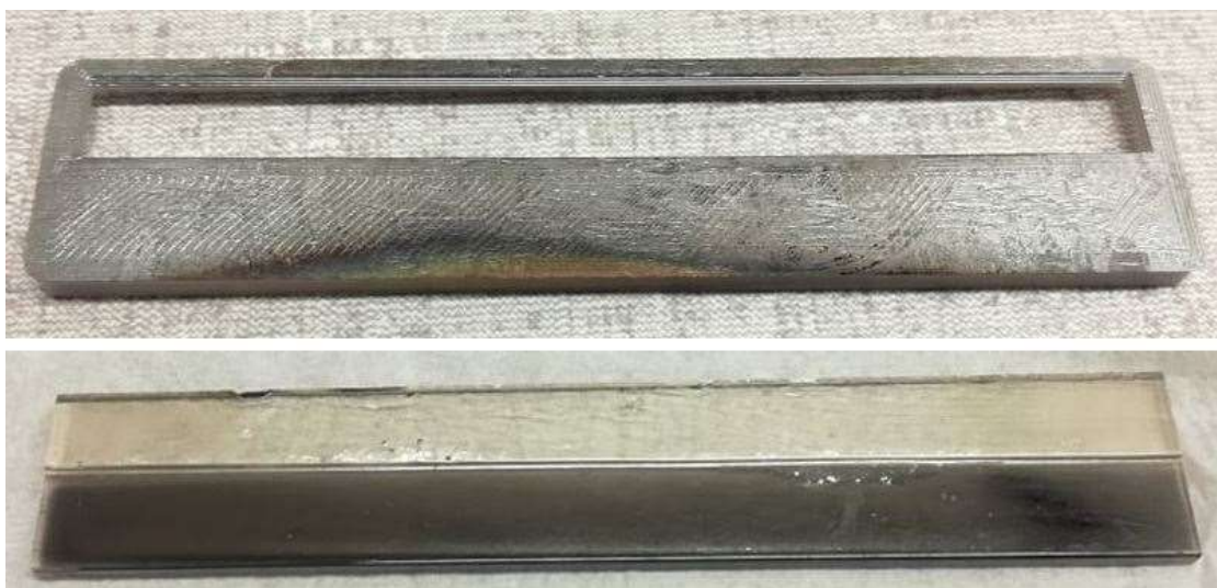
Fig. IV. 11. Dépôt des couches minces Pt-Pd par sputtering à l'aide d'un masque conçu spécifiquement (ci-haut)
