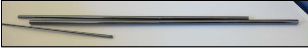
Fig. V. 6. Tiges GST cœur/gaine préparées par fibrage
