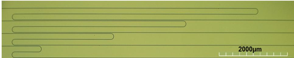
**FIGURE 5.19** – Photographie au microscope optique des motifs de guides d’onde slots permettant la mesure des pertes linéaires après insolation en lithographie laser.
