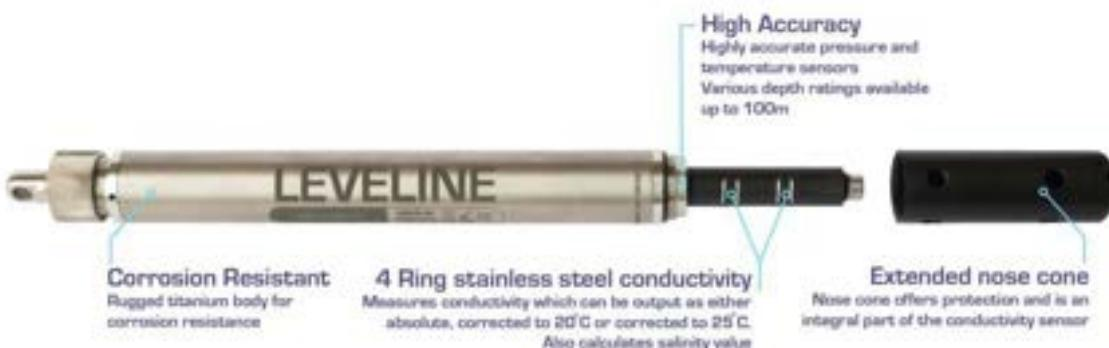
Le LeveLine CTD est fabriqué à partir de titane et est idéal pour un déploiement à long terme dans les environnements les plus difficiles. Il a également une précision de pointe, une mémoire de 500 000 points de données et une sortie directe SDI12 / RS485. Les variantes absolues ou de jauge doivent couvrir toutes les applications habituelles de l'eau souterraine à l'eau de surface.
