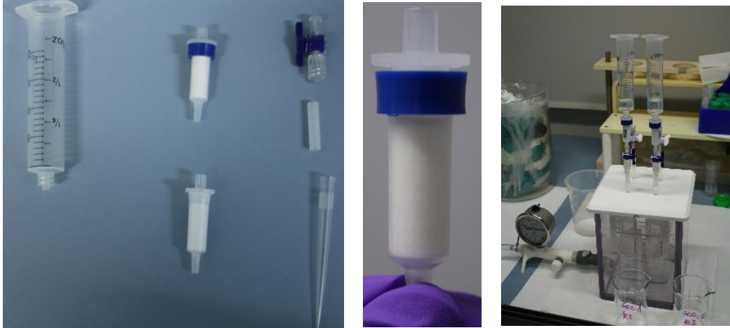
Figure 33 : Matériel nécessaire pour la séparation sur boîte à vide (gauche) ; cartouche pour boîte à vide de 2 mL (milieu) ; boîte à vide 4 positions avec deux cartouches (droite)
