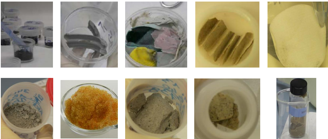
Figure 9 : Echantillons solides, graphites, métaux, déchets technologiques, filtres, frottis (haut de gauche à droite) ; bétons, résines échangeuses d'ions (REI) ; REI immobilisées dans du béton ; REI immobilisées dans un polymère organique ; boues (bas de gauche à droite)
