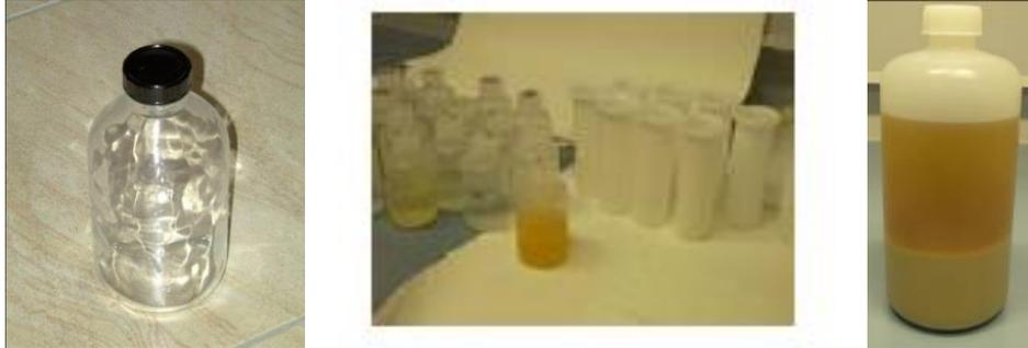
*Figure 10 : Echantillons liquides, effluents (gauche), huiles (milieu), concentrats (droite)*
