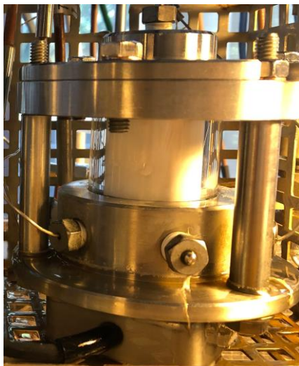
Figure 38 : Photo de la cellule de mesure pour la formation et dissociation des hydrates, la cellule de référence est identique. Ces cellules sont en verre pour permettre la visualisation de l'échantillon notamment lorsque les hydrates sont formés en milieu bulk
