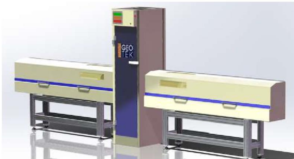
Figure 33 : Dispositif d'imagerie par tomographie assistée par ordinateur (CT-scan Xray tomography)
