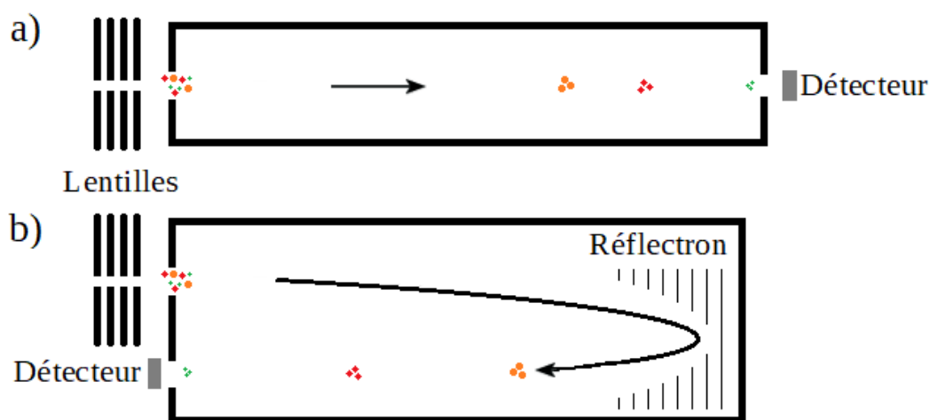
Figure 17: Schéma d'un analyseur TOF a) linéaire, b) avec un système réflectron
