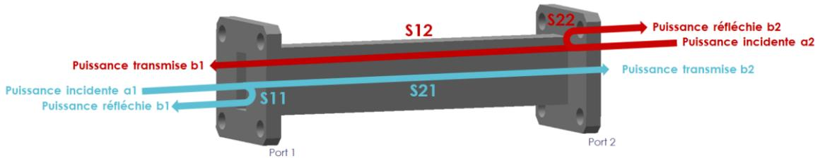
Figure 19 : Représentation des ondes incidentes et réfléchies aux ports d'un guide d'ondes et illustration des paramètres de répartition [62].
