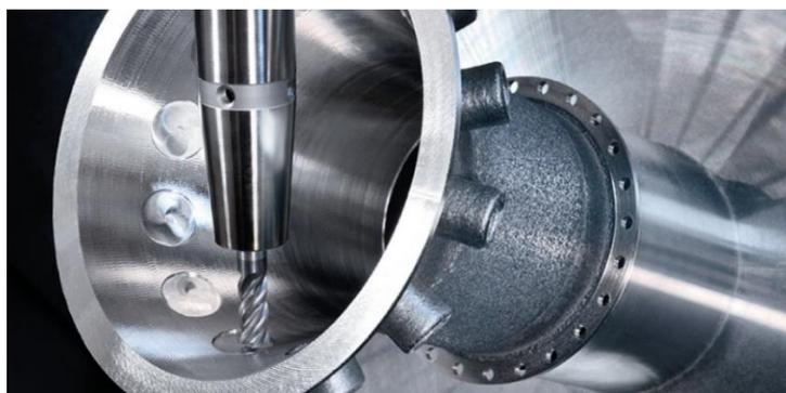
Figure 13 : Opération post-rechargement sur une machine 5 axes [54].
