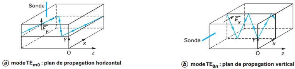
Figure 16 : Propagation des ondes dans un guide d'ondes rectangulaire [61].
