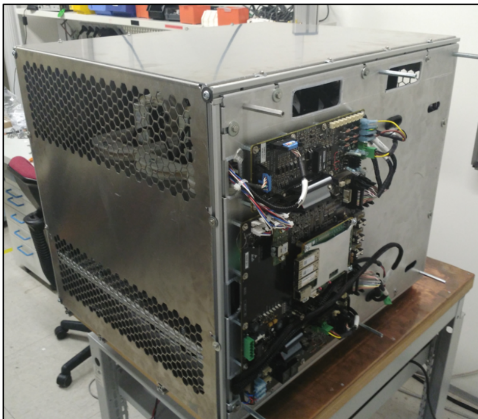
FIGURE 3.19 – Photo du prototype de l'AR monté avec sa tôle. Seules sont visibles des cartes électroniques de la régulation (en bas) et d'interface avec les capteurs de mesures (en haut).
